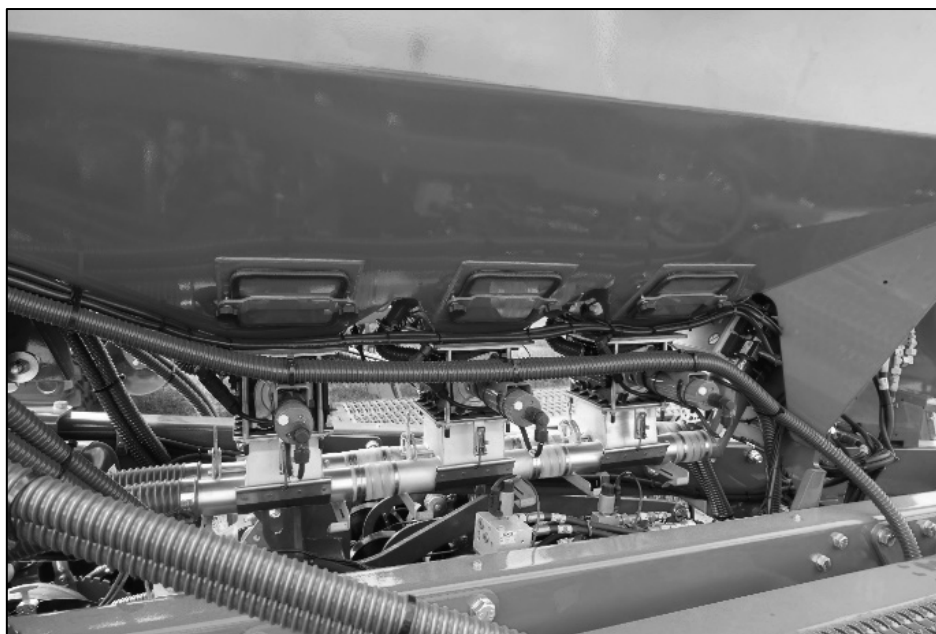
Obr. 5: Dělený zásobník s vícenásobným počtem výsevních ústrojí
