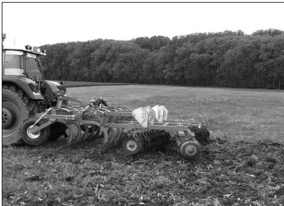
Obr. 4: Hlubkový kypřič při práci
