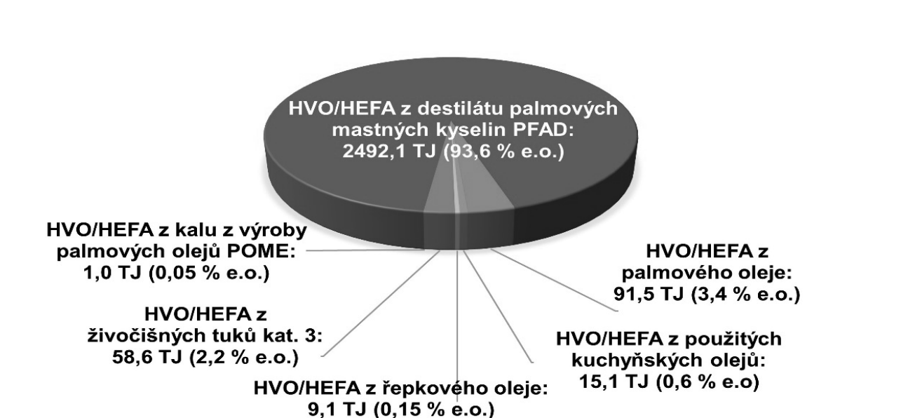
Obr. 6: Energetické a procentní podíly HVO/HEFA vyrobených z použitých vstupních surovin a spotřebovaných na tuzemském trhu s pohonnými hmotami v roce 2021 (celkem HVO/HEFA 2 661,4 TJ; bez multiplikátorů)
