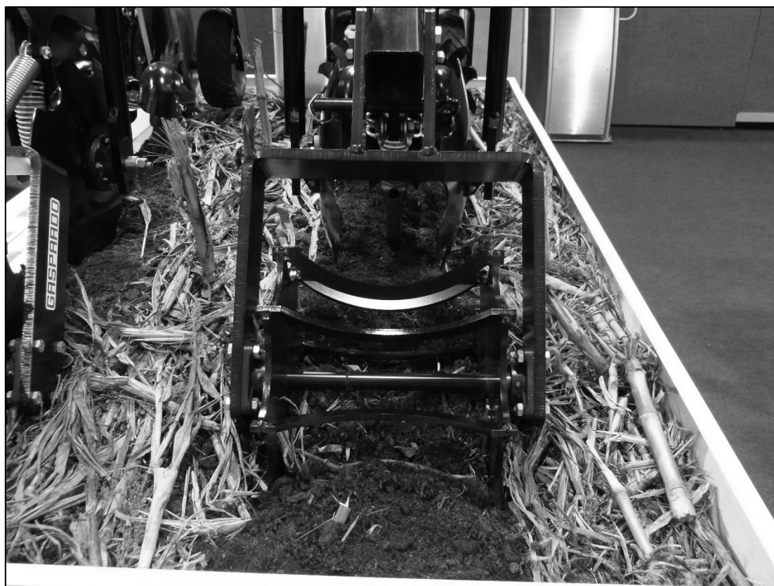
Obr. 7: Upravený řádek po strip-till
